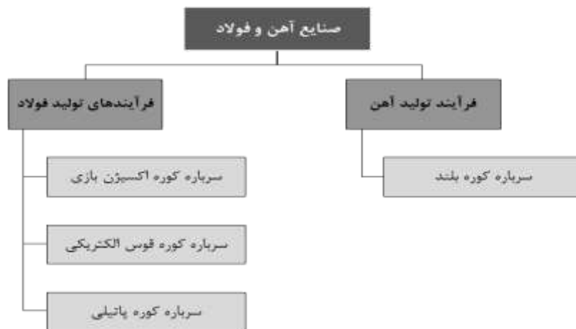
شکل (۳-۱): انواع سرباره‌های آهنی بر اساس فرآیندهای تولید
