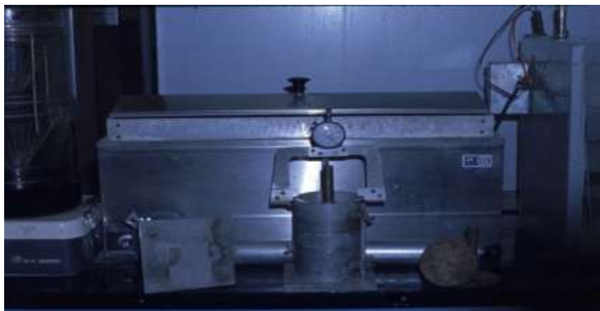
شکل (۲-۳): تصویر آزمایش انبساط حجمی طبق استاندارد ASTM D4792 (Wang, 2016)
