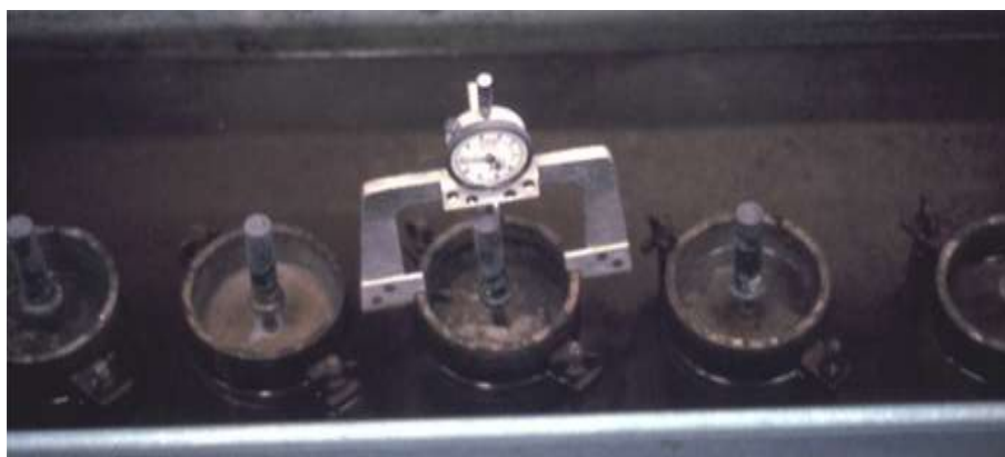
شکل (۲-۴): انجام آزمایش انبساط حجمی بر روی چند نمونه به صورت همزمان (Wang, 2016)
