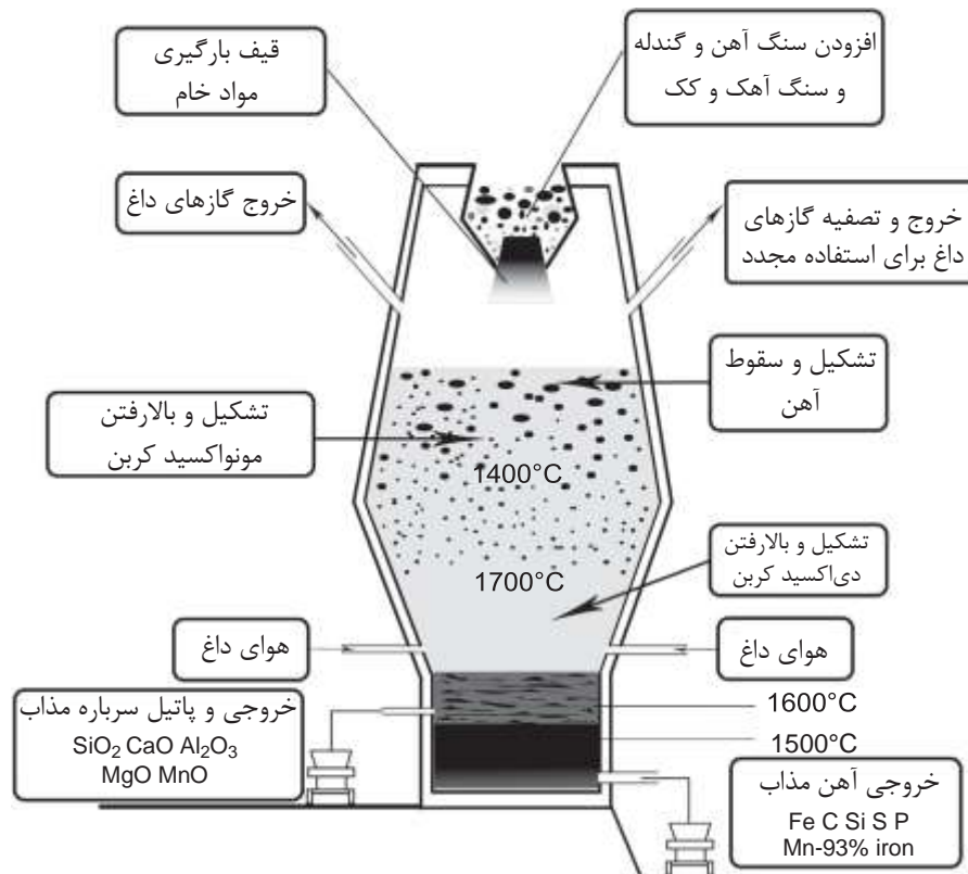
شکل (۱-۱۲): تصویر شماتیک کوره بلند BF (Wang, 2016)
